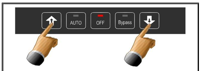
步骤6：务必按OFF钮变换至下一个相位校正或直到“End”出现在屏幕。若要立即结束程序设定则按住OFF钮4秒不放，即可离开程序。
