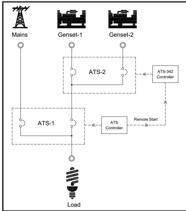
当市电电源质量异常时，ATS-342 控制模块接受遥控起动信号自动执行备用发电机组之起动与切换。当运转供电中之发电机组发生故障，无法继续提供稳定且安全之电力质量供负载用电时，ATS-342 控制单元将自动启动备用发电机组接续负载供电。
