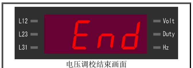
步骤7：若屏幕显示(FAIL)则表示校正无效，轻按OFF钮清除告警讯息，并依步骤1开始重新操作。
