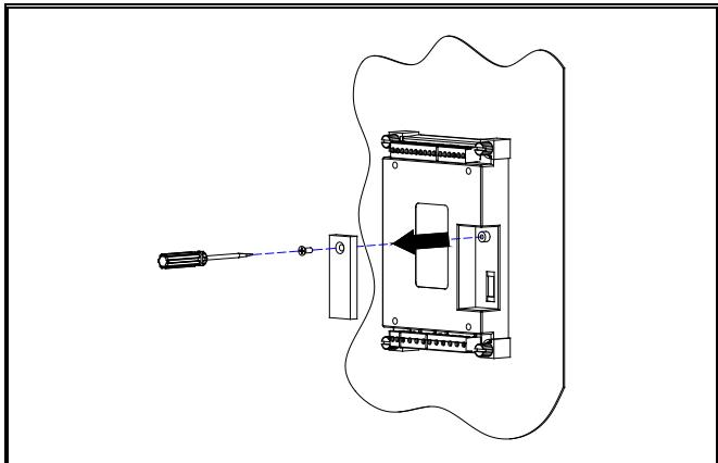
步骤2：将KCU-XX模块插入ATS-342的控制模块，并将螺丝锁紧。
