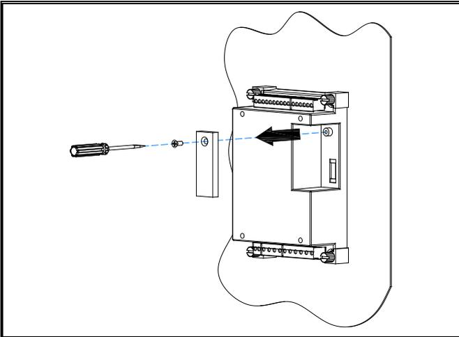
步驟2：將KCU-XX模組插入ATS-465的電路板，並將螺絲鎖緊。
