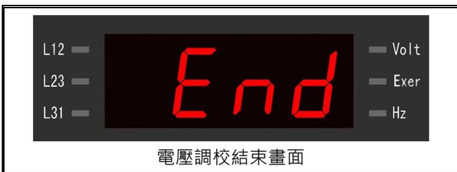
步驟7：若螢幕顯示(FAIL)則表示校正無效，輕按OFF鈕清除告警訊息，並依步驟1開始重新操作。
