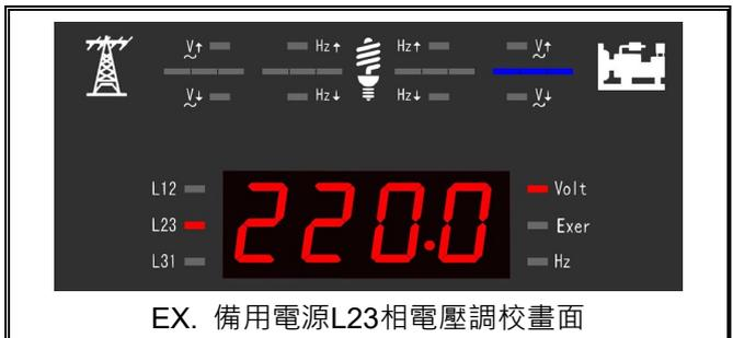
步驟4：使用準確的三用電表讀取欲校正的相位電壓值。
