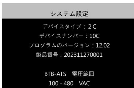
自動電源切替スイッチのすべてのパラメーターは操作パネルから直接設定できます。システムパラメーター設定モードに入るには、OFFモードでプログラムバージョン画面が表示されるまで **OFF** を 4 秒間長押ししてください (左図)。
