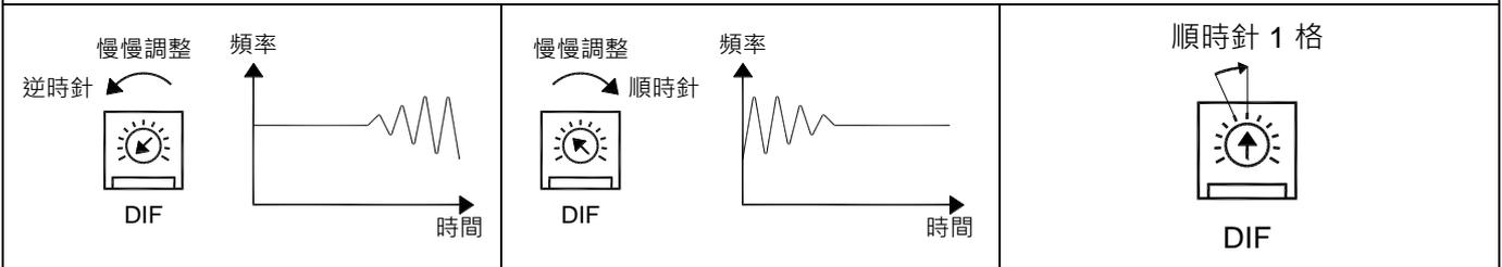
6.4 用手拨动致动器连桿或投入负载，观察电压频率回复情况，正常应会迅速回复稳定，如需再调节可重复步骤 6.2 及 步骤 6.3 再重新调节。
