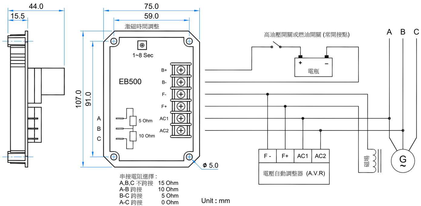
注意: 本產品不適合使用於 N 相直接接地的發電機 · EB500 動作時會短路 (因電瓶共地)
