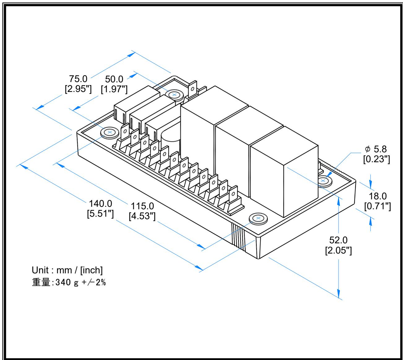
GCU-14R モジュール基板は UL94V-0 絶縁樹脂でポッティング処理されており、耐腐食性と高い絶縁耐圧特性を備え、特に厳しい使用条件下での利用に適しています。
